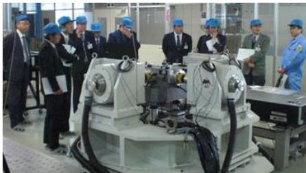
多軸慣性センサ、IMUの評価ツール
